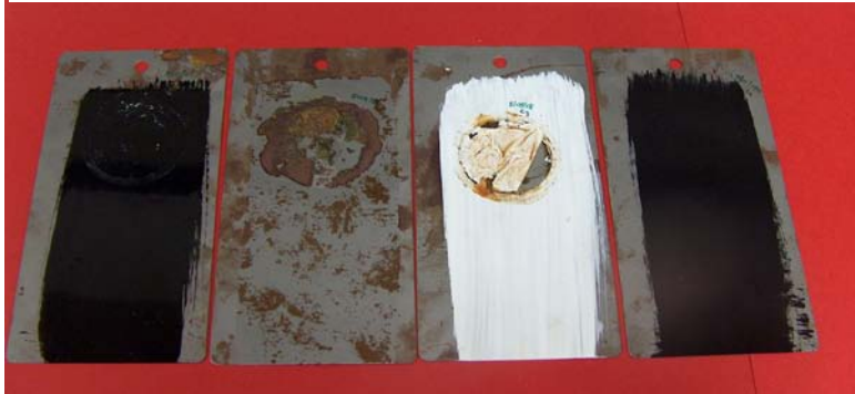
Figura 3. Estado final de las planchas tras ensayo mediante técnica AC/DC/AC.
